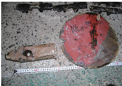
鉄製ハンマーのヘッド 直径30cmの円形鉄板 (重量40kg) 20cmの金属異物46個
