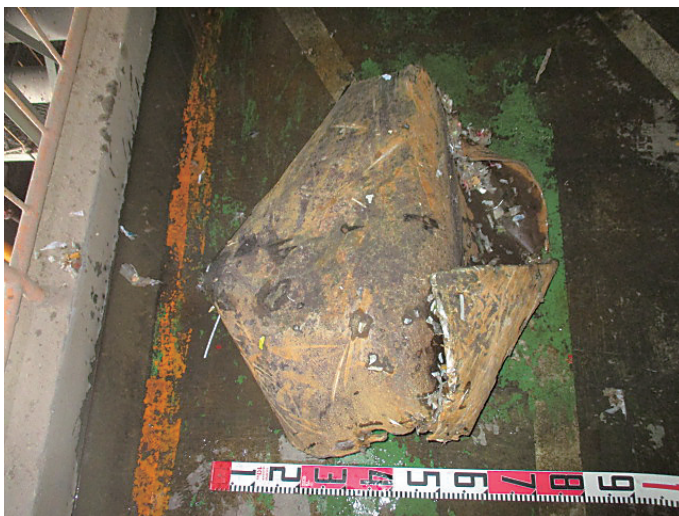
縞鋼板 (寸法 120cm×90cm×1.2cm重量 約100kg程度)
